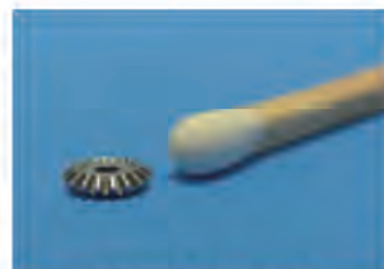
▲ 医療機器用小型かさ歯車 (材質：SUS304／モジュール：m0.3／ 歯数：16枚／穴径：φ1.5)
